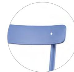
Sedile in lamiera stampata saldato alla struttura e schienale fissato con rivetti in acciaio inox. Tali rivetti riducono il rischio di corrosione, ruggine e deterioramento da agenti atmosferici.
