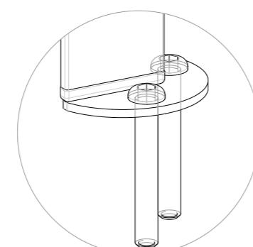
Possibilità di fissaggio a terra tramite placca in acciaio inossidabile.
