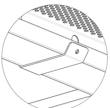
Connettore di fissaggio fra moduli.
