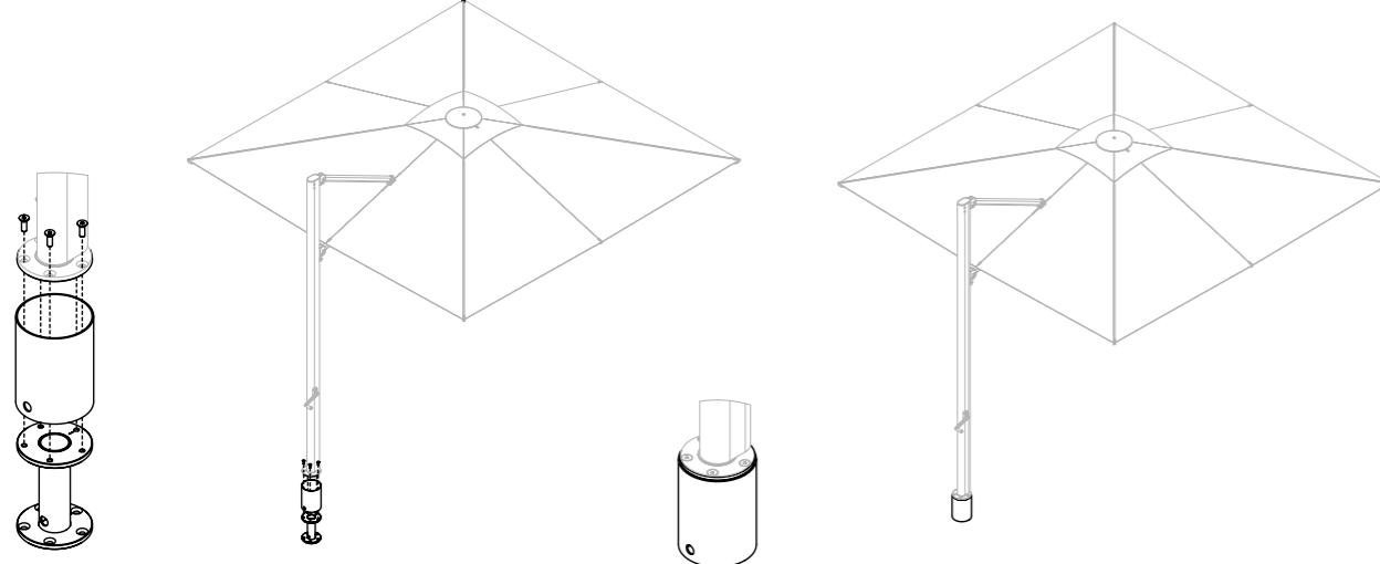
Elemento di rialzo in acciaio prezzincato a caldo che può essere fissato a terra tramite viti. E' dotato inoltre di un apposito cilindro esterno che ne permette la copertura per una migliore pulizia estetica.—This pre hot-dip zinned raising plate can be fixed to the ground with screws. It's also equipped with a specific external cylinder which allow to cover it for a high aesthetic refinement.
