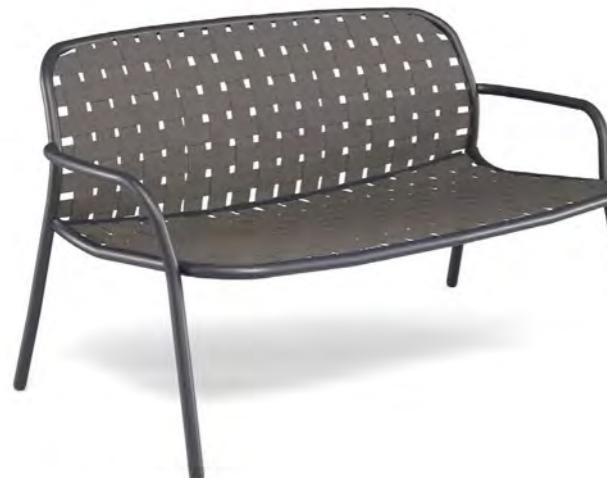
Sistema di fissaggio cinghie brevettato EMU. I tubolari di seduta e schienale hanno un canale interno che permette l'inserimento delle varie cinghie, il loro intreccio e il fissaggio. Tale sistema, risultato di una specifica soluzione tecnica originale EMU e brevettata, permette la sostituzione di cinghie in caso di danneggiamento.
